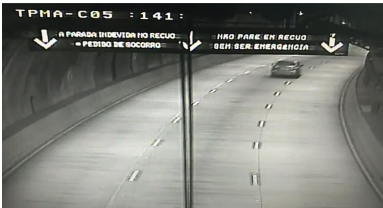
Figura 18: Imagens das câmeras de segurança dos túneis com as novas mensagens do PMV em funcionamento. Fonte: Imagens fornecidas pelo CCO
