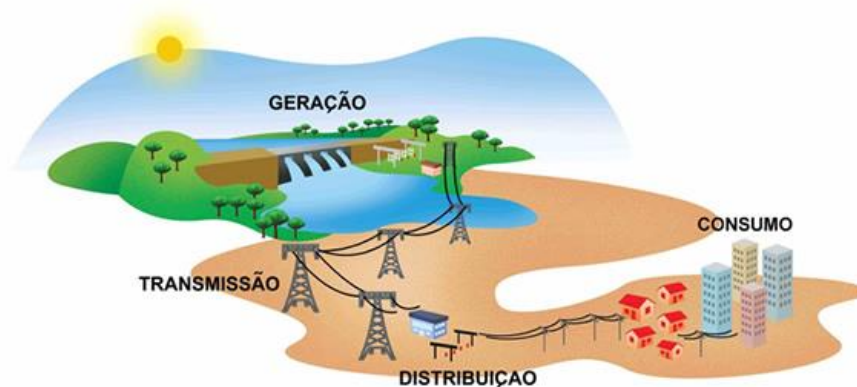
Figura 4 – O caminho da energia elétrica
